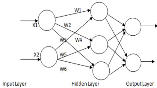
FIG (3) – Multi layer Preceptron.
