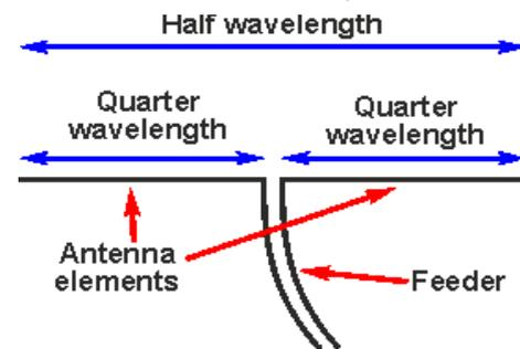
Fig. 1. A dipole wire
