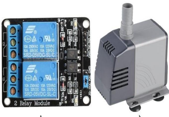
Fig. 6 a. 2Relay Module b. Motor
