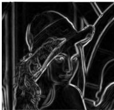
Figure 4: The edge detection using Perwitt edge detector
